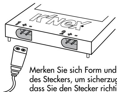
Merken Sie sich Form und Polung des Steckers, um sicherzugehen, dass Sie den Stecker richtig in das Solarmodul gesteckt haben. Das Netzkabel muss ganz an die Buchse angeschlossen sein.
