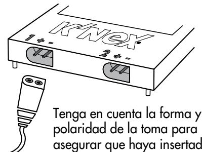
Tenga en cuenta la forma y polaridad de la toma para asegurar que haya insertado el enchufe correctamente en el panel solar. Los enchufes del cable de alimentación deben estar plenamente conectados a las tomas.
